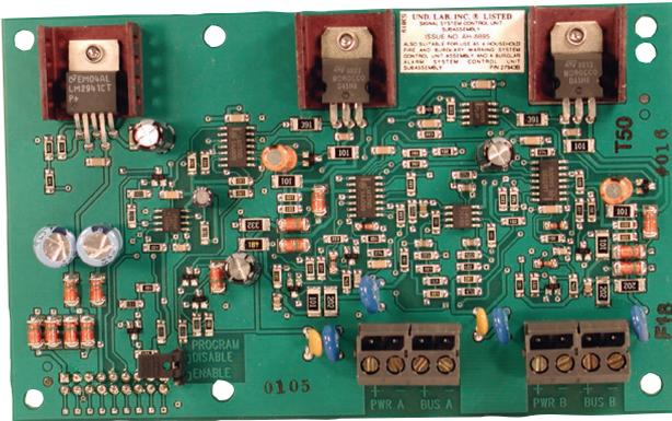
DS7436 是一款双回路的多路复用总线扩展模块，可以与 DS7400Xi 系列控制主机配合使用。它与 DS7400Xi 板直接相连，可为最多 120 个远程防区提供双芯多路复用总线。各总线相互独立，当一条总线出现故障时，不会影响其它总线。
