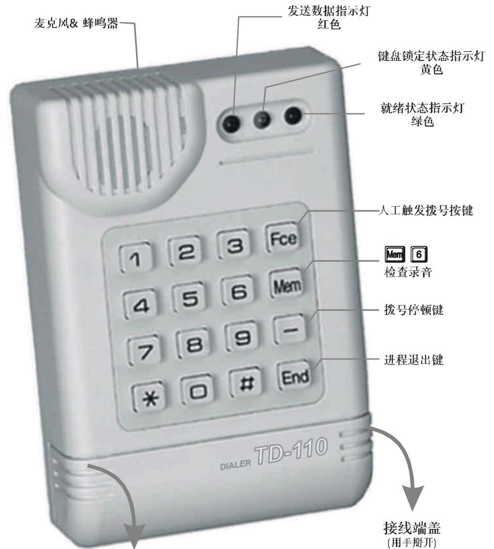
TD110型自动电话拨号器能将事先录制好的语音信息传送给四个普通型电话或移动电话的电话号码, 甚至能向传呼台传送数字型传呼信息。
